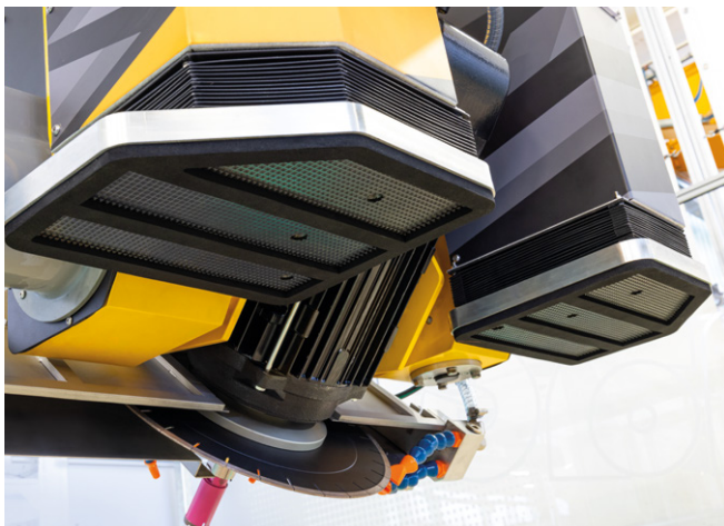
Vacuum lifter / Ventosa per taglio ottimizzato
